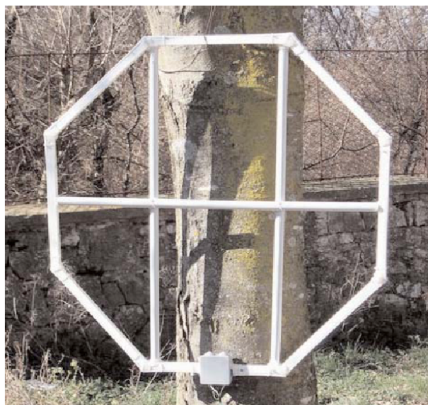
Slika 1. – Octoloop antena (prilikom uporabe izbjegavati blizinu stabala, jer su dobri uzemljivači za EM signale)
