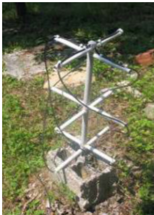
Prijem 3 preleta NOAA 19, pomoću QFH i RTL sdr sticka:
